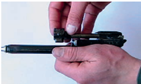
• Від'єднання затвора від затворної рами
