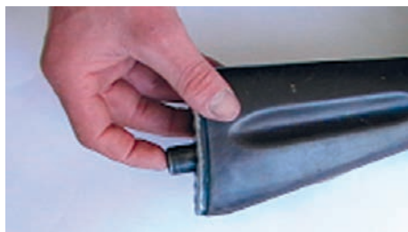
• Виймання пенала з гнізда приклада
