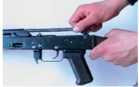
• Від'єднання зворотного механізму
