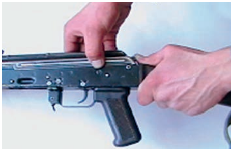
• Від'єднання кришки ствольної коробки
