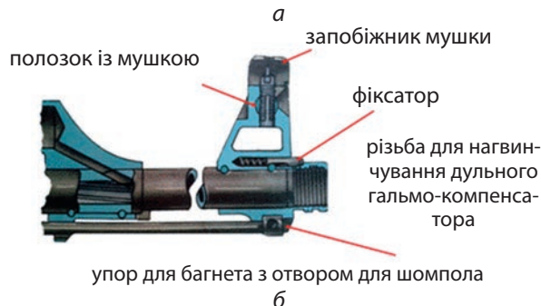
• Прицільний пристрій: а – приціл; б – мушка
