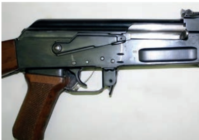
• Автомат встановлений на запобіжник
